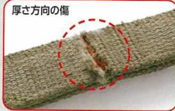
※写真は実際に屋内工場で使用されていたキトーベルトスリングで、破損時のイメージです。
