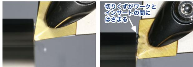
切りくずがワークとインサートの間にはさまる
