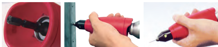
インパクトドライバーの正転で リベット締結
