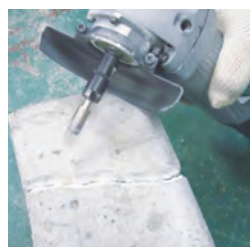
※コレットチャック(別売)でディスクグラインダーにもご使用いただけます。
