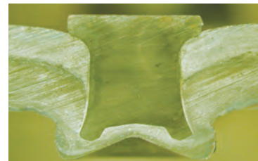
ホールレスリベット締結(断面図)
