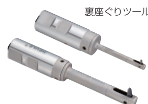
センタスルークーラントで ブレードを開閉 BFカッター
