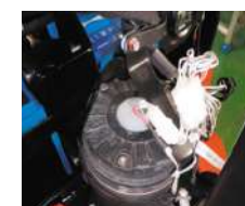
ドライブホイールはブラシレスモーターを使用しています。
