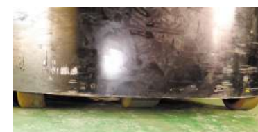
つま先が入らないように床とカバーの 隙間は5cmになっています。
