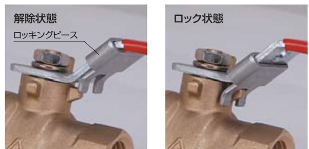
●ロッキングピースが移動して 全開又は、全閉位置でのハンドルの回転を制限します。ハンドルに物をぶつかけたり、押ししてしまうなどの誤操作を防止できます。(製品記号：600RP-LL)
