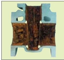
激しく腐食した鋳鉄バルブの内部
