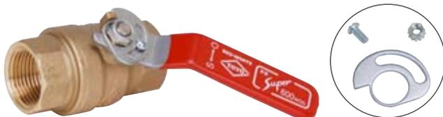
メモリーストップ板をレバーハンドルに取付け、前以って任意の開度に調整しておけばいつもボールバルブを同じ開度位置に保てます。ご使用になる際には高速流体配管における中間開度位置での長期間放置は著しくシートの封止性能を低下させ、シート漏れを生じることがあります。特に微小開度ではバルブを損傷することがありますのでご注意ください。このメモリーストップ板は、下記の機種のみ50<sup>A</sup>までオプション仕様として取付けられます。(主に空気圧配管に利用します)
