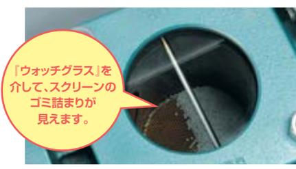
●スクリーンの清掃時に水(油)抜き養生が不要。
