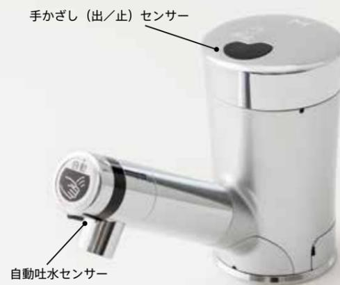
吐水口先端と本体天面の2箇所にセンサーを搭載した高機能タイプの自動水栓です。手を洗う時に水が出る通常の操作に加え、水の(出/止)も非接触で操作できます。
