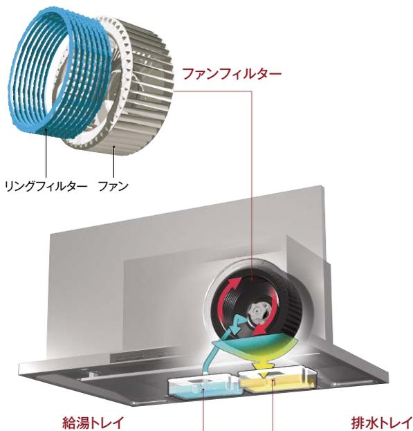
フィルターをファンと一体化させた新構造のファンフィルターをお湯で浸け置き洗い。お湯を掻き揚げる動作によって生じる水流を繰り返し衝突させることで汚れを除去。排水は排水トレイに溜まります。
