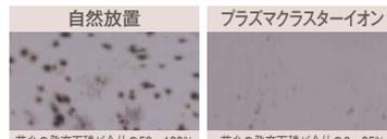
●試験依頼元：(財)日本食品分析センター ●試験成績書：2009/10/27第09010744001-01号 ●試験方法：JISZ2911を参考に、塩ビ板上で5日間カビを増殖させたものを依頼。JISZ2911を参考に、カビ増殖面積を比較。(プラズマクラスターイオン濃度：25,000個/cm<sup>3</sup>) ■試験結果：5日後に付着カビ菌の増殖を抑制。
