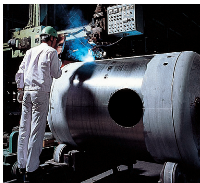
マニピュレーター (長手及び周継手自動溶接機) Manipulator
