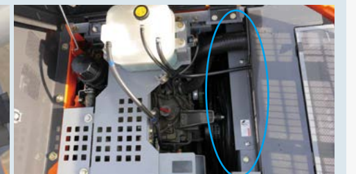
ワンタッチ開閉式のラジエタ清掃窓
