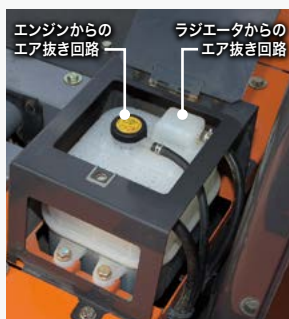
エキスパンションタンク
