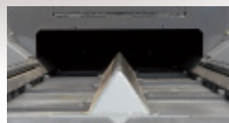
コンベヤ中央チェーンカバー
