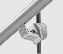
アルミダイカスト製 アクリル焼付塗装仕上 対応ブラケットは小ブラケット
