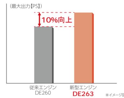
4流掃気シリンダの採用で、新しい混合燃料の流れがスムーズになりました。少ない燃料でも燃焼しやすくなり、燃費の向上、馬力UPを実現しました。
