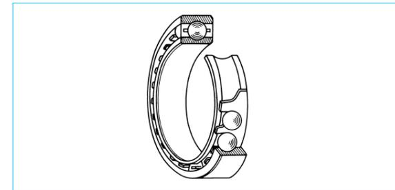
内径に対する外径の比が標準より小さい深溝玉軸受である。この軸受を使用することにより、装置の小形軽量化が図れる。
