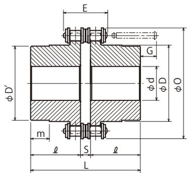
チェーンカップリングは、2列ローラチェーンとそれにかみ合う2個のスプロケットで組立てられた軸継手です。チェーンの一端は簡単に連結分解することができます。ケースは軸と直角方向に二つ割れる様になっており、KC3012~KC8022のケース両側にはV溝を有し、O(オー)リングを入れて油漏れを防止するKANA独自の構造となっています。
