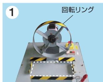
回転リング側に正面を向くようにコードリールを置きます。(点線部)
