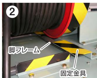
コードリールの脚フレームを固定金具に挿入します。
